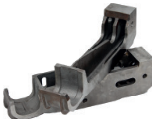
Vorschub-Rückschubstab moving/return grate bar
