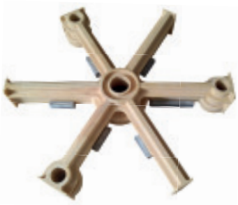
Grundkreuz (Wachsmode)l base spider (wax pattern)
